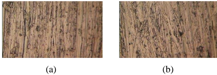
Gambar 4.3 Foto mikro hasil proses end milling pada spindle speed 700 rpm (a) tanpa magnet (b) dengan magnet
