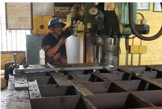
Gambar 4.5 Proses machining menggunakan mesin bor
