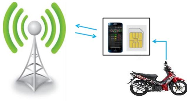
Gambar 3.1 Konfigurasi alat pengukuran *drivetest*
