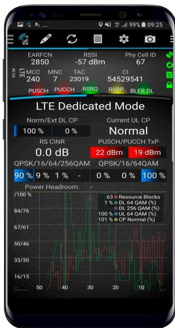
Gambar 2.2 Mobile Phone sebagai alat drivetest
