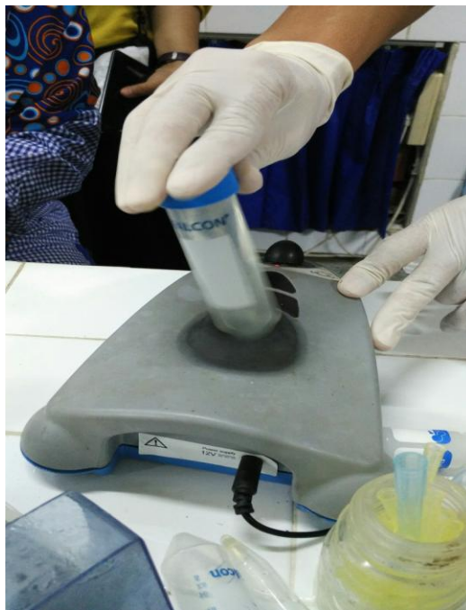
Proses pengenceran ekstrak daun kelor menggunakan mesin vortex
