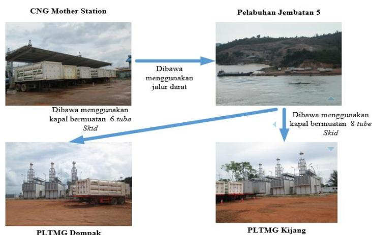
Gambar 1.2 Alur distribusi CNG ke PT. PLN Batam
