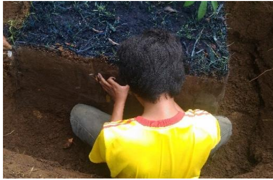
Gambar 2. Pengukuran makroporositas menggunakan methylene blue
