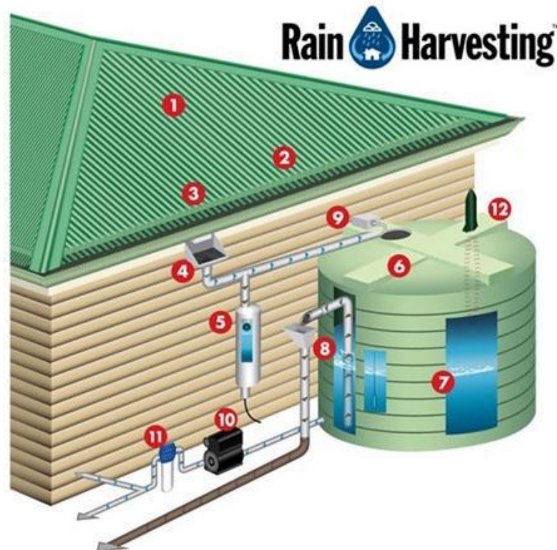
Gambar 2.4 Komponen Bagian-bagian Pemanen Air Hujan
