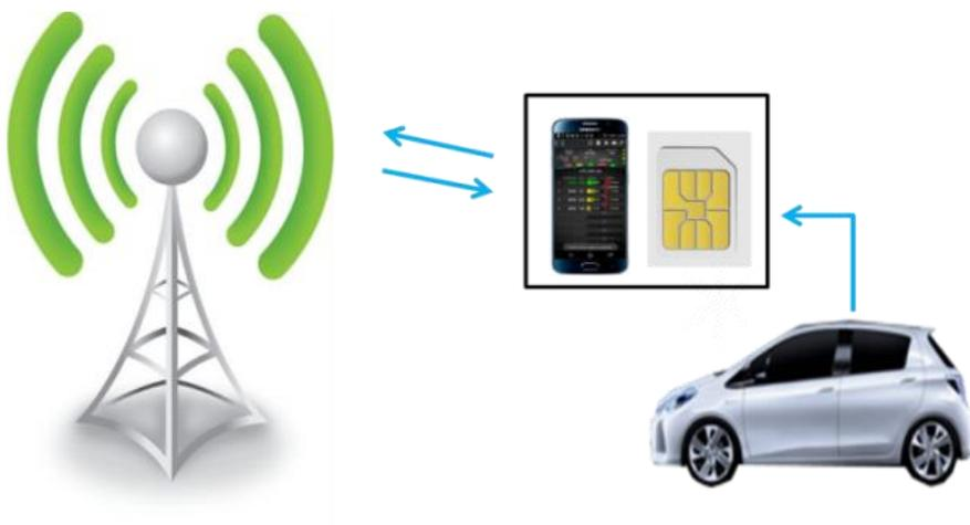
Gambar 3.2 Konfigurasi alat pengukuran drive test
