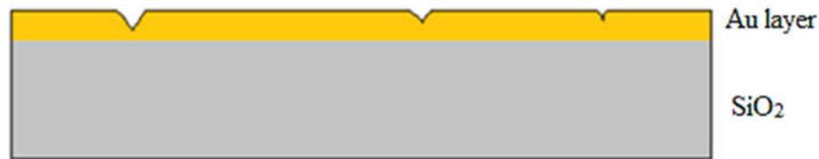
Gambar 2.4 Deposisi *masking* Au diatas film SiO<sub>2</sub>
