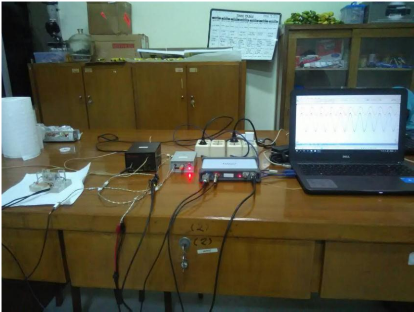
o) Set Rangkaian Pengukuran Impedansi Listrik
