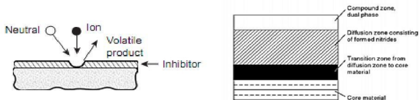
Gambar 2.9 Ion Bombardment b. zona struktur lapisan yang terbentuk (Friedman, 2008)
