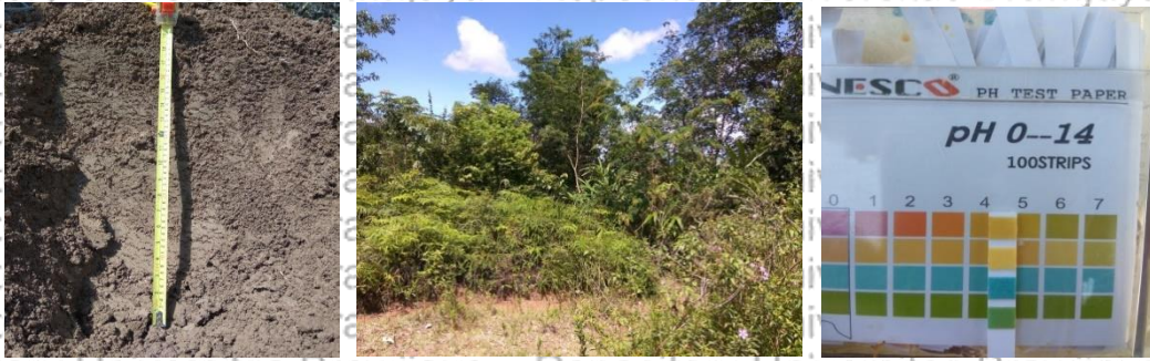
(a) (b) (c) Gambar 18. Titik Pengamatan 12 (a): minipit, (b): kondisi lokasi, (c): pengukuran pH di lapangan
