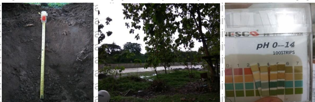
Gambar 14. Titik Pengamatan 8 (a): minipit, (b): kondisi lokasi, (c): pengukuran pH di lapangan
