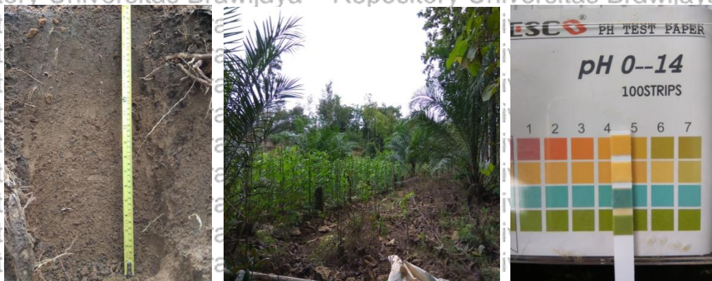
Gambar 12. Titik Pengamatan 6 (a): minipit, (b): kondisi lokasi, (c): pengukuran pH di lapangan
