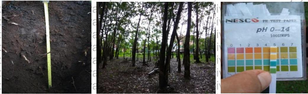
Gambar 13. Titik Pengamatan 7 (a): minipit, (b): kondisi lokasi, (c): pengukuran pH di lapangan
