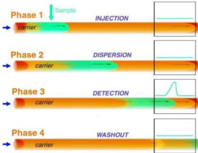
Gambar 2.6: Fase yang terjadi saat sampel mulai diinjeksikan hingga proses pembilasan [9]
