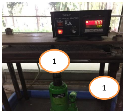
Gambar C. 2 Hydraulic-press dengan Sistem Pemanas
