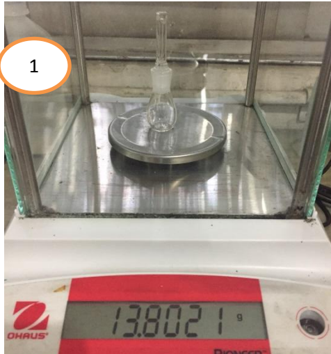
Gambar C. 3 Piknometer ditimbang di Neraca
