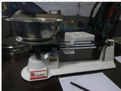
Gambar 4.17 Penimbangan agregat untuk pengukuran kadar air
