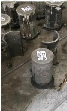
Gambar 4.25 Benda uji dibuka setelah dibiarkan selama 24 jam
