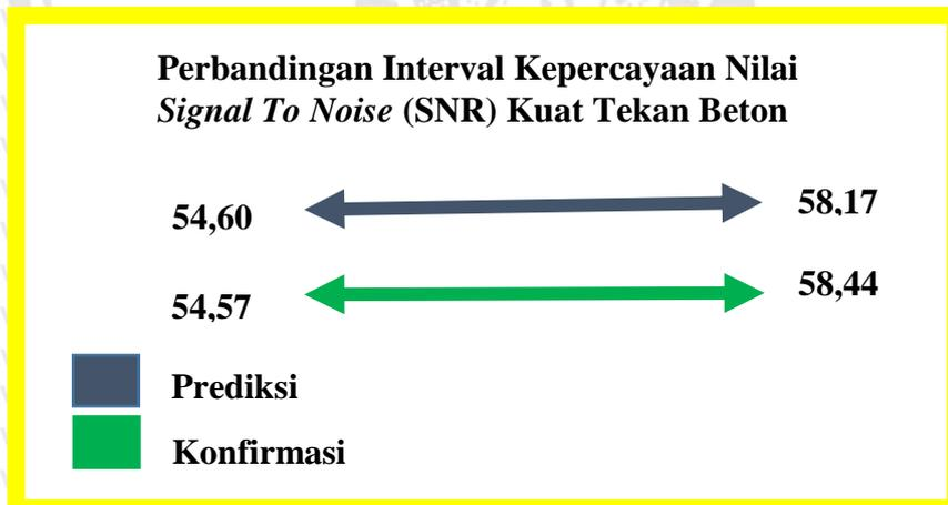
Gambar 4.30 Perbandingan interval kepercayaan prediksi dan eksperimen konfirmasi pada nilai *Signal To Noise* (SNR)
