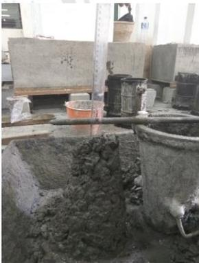
Gambar 4.23 Pengukuran Slump
