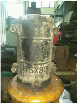
Gambar 4.9 Cetakan silinder
