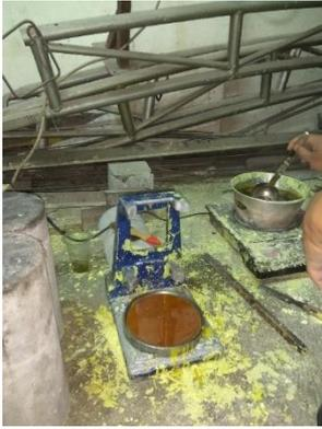
Gambar 4.10 Alat capping dan kompor listrik
