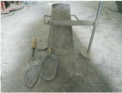
Gambar 4.8 Alat-alat pengujian Slump
