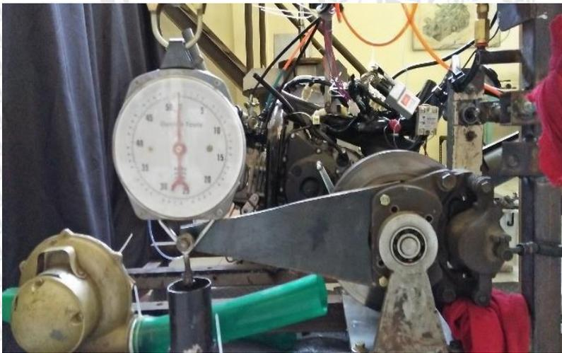
*Gambar 3.3* Dinamometer
