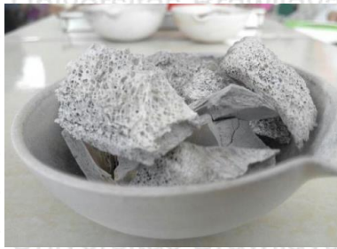
Gambar 2. 5 Tulang Sapi yang Telah Dikalsinasi pada Suhu 1000°C
