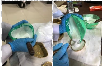
Gambar 4. 4 Pengisian adonan gips pada kuvet bawah
