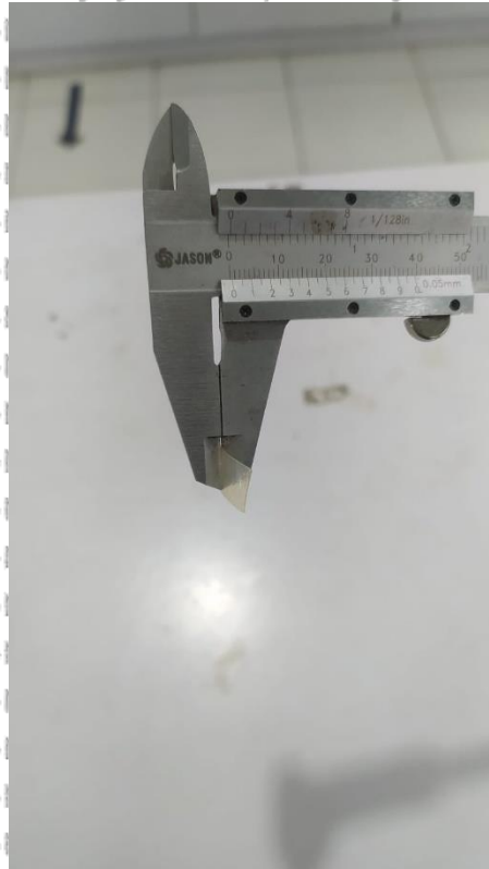
Gambar 5. Dokumentasi uji ketebalan patch
