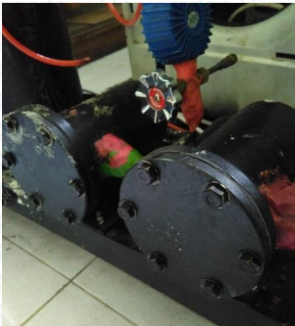
Gambar 3.9 Tabung purifikasi zeolit
