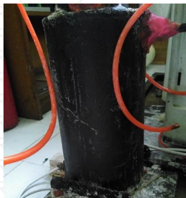
Gambar 3.8 Tabung Purifikasi NaOH
