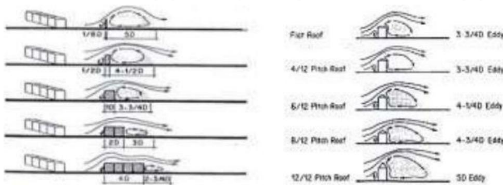
Gambar 2.4 Pengaruh dimensi dan bentuk bukaan dari bangunan terhadap ukuran bayangan angin
