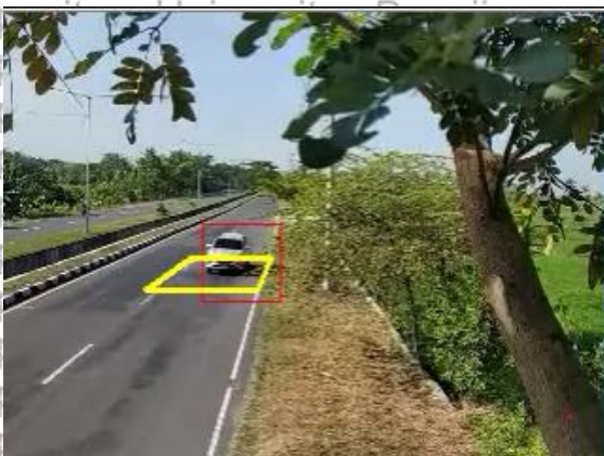
Gambar 5.37 Tampilan hasil deteksi mobil pada ROI
