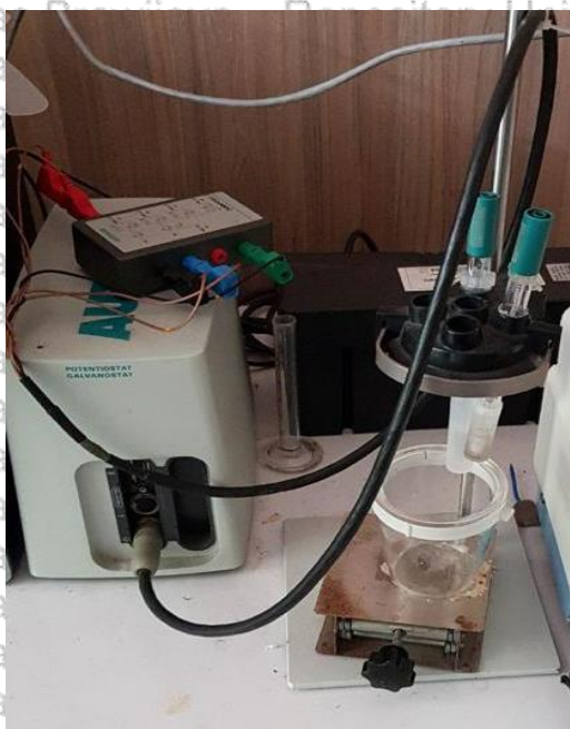
Gambar 3.7 Alat ukur laju korosi AutoLab PG STAT 204
