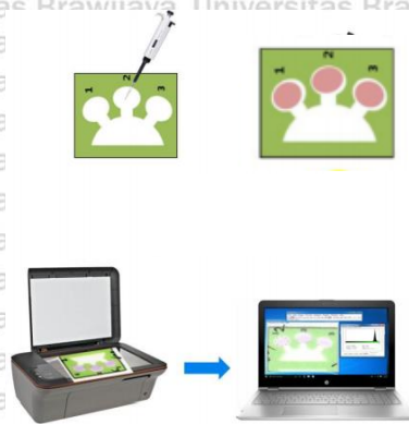
Gambar 2.6 Ilustrasi Deteksi Kolorimetri Cr (VI) pada \mu\text{PADs} [23]
