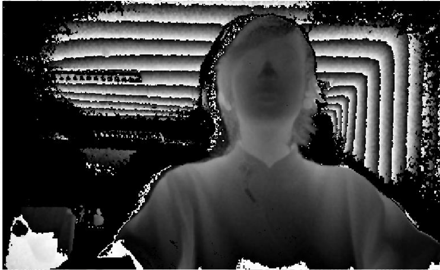
Gambar 3.3 Gambar kedalaman yang diperoleh menggunakan Kinect
