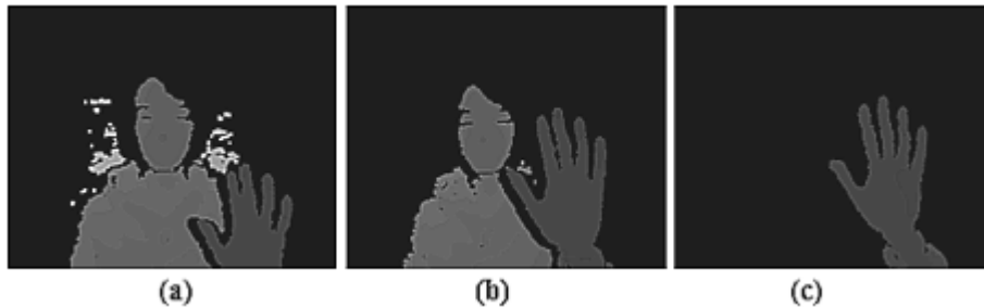
Gambar 3.4 Proses Segmentasi (a) Gambar kedalaman asli, (b) Gambar kedalaman setelah penghapusan latar belakang, dan (c) hasil segmentasi tangan
