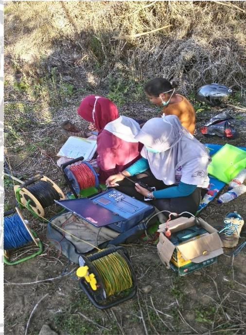
Gambar L3.1 Pengambilan data geolistrik resistivitas
