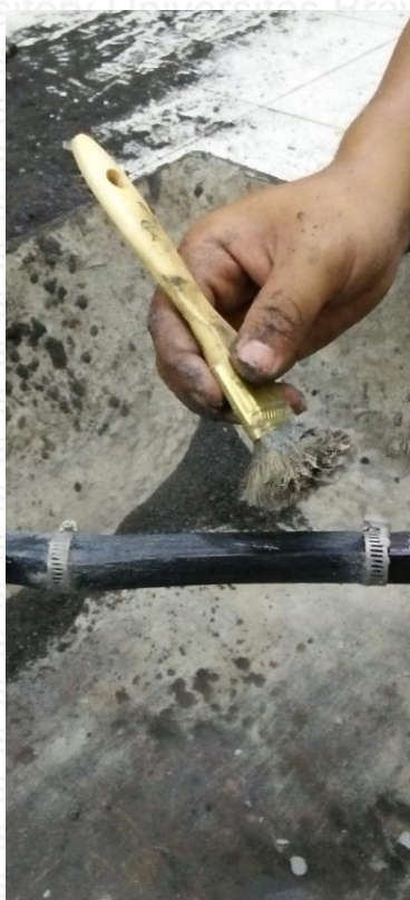
Gambar Proses Pelapisan Sikadur pada Bambu dilanjutkan dengan pelapisan Pasir
