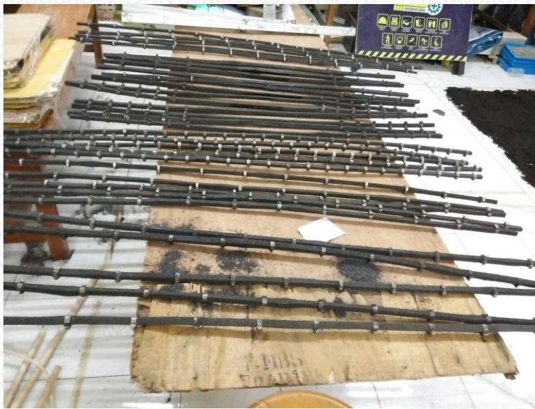
Gambar Tulangan bambu uji Pull Out yang siap dipasang dibekisting
