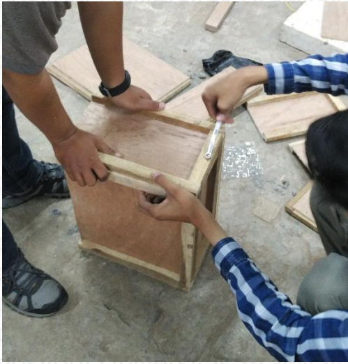
Gambar Pemasangan bagian-bagian bekesting benda Uji Pull Out
