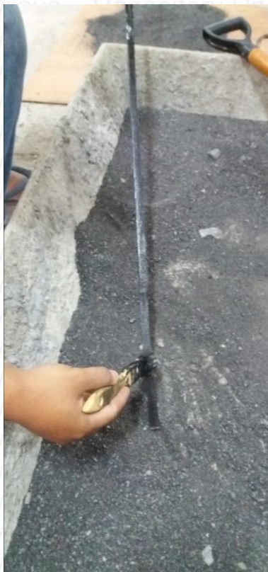
Gambar Proses Pelapisan Sikadur pada Bambu dilanjutkan dengan pelapisan Pasir
