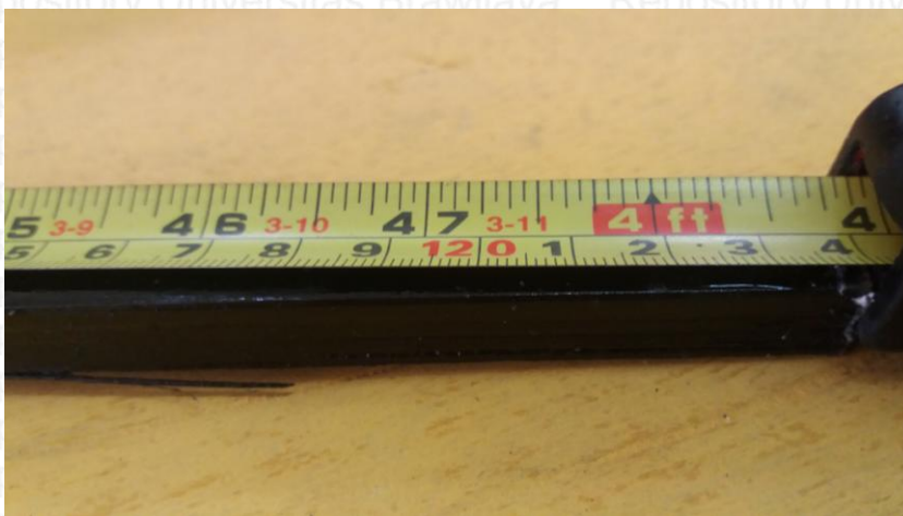
Gambar Pengukuran Panjang Tulangan (Panjang 124 cm)
