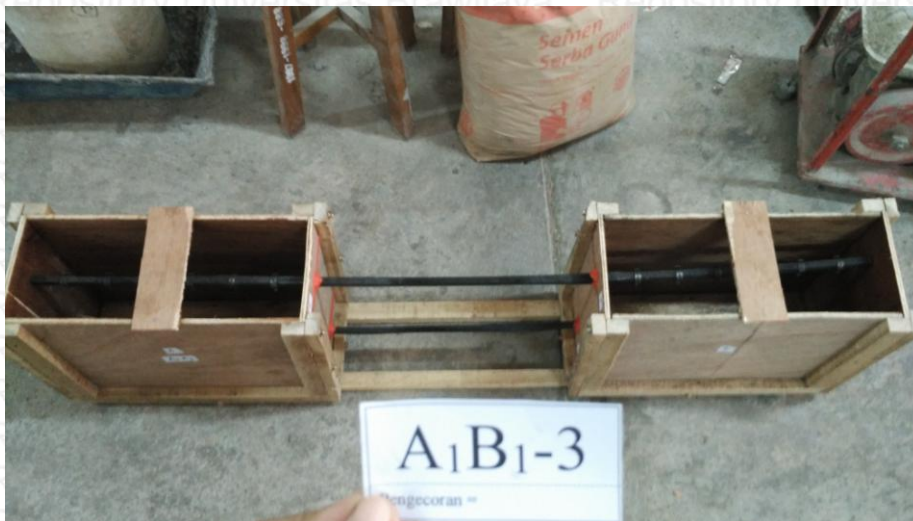
Gambar Bekesting yang sudah diolesi dengan oli dan siap untuk dicor
