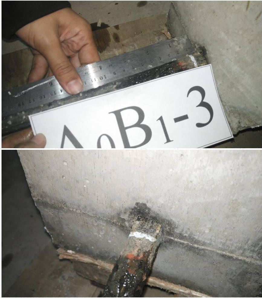
Gambar Keruntuhan Benda Uji Pull Out A 0 B 1 -3
