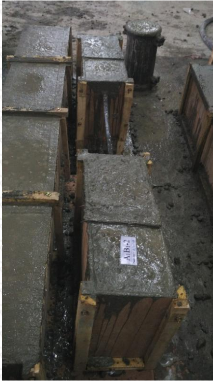
Gambar Benda Uji Pull Out yang sudah dicor
