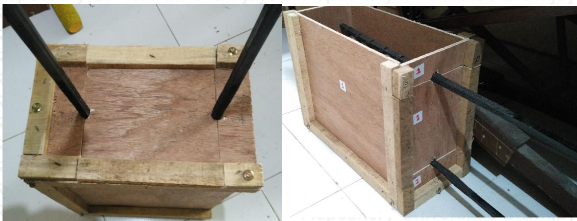
Gambar Pemasangan tulangan bambu pada bekesting benda Uji Pull Out
