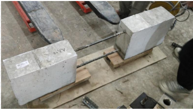
Gambar Penempatan Benda Uji Pull Out pada tumpuan sendi dan tumpuan roll
