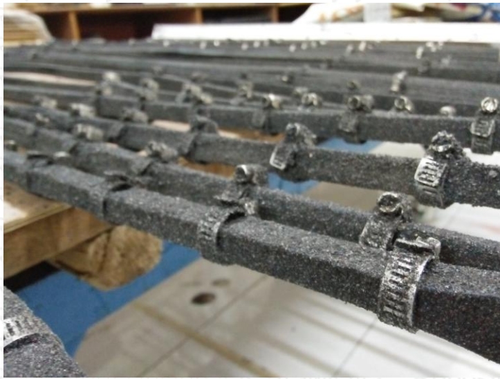
Gambar Pengeringan Tulangan Bambu sudah dipasang klem selang dan dilapisi pasir
