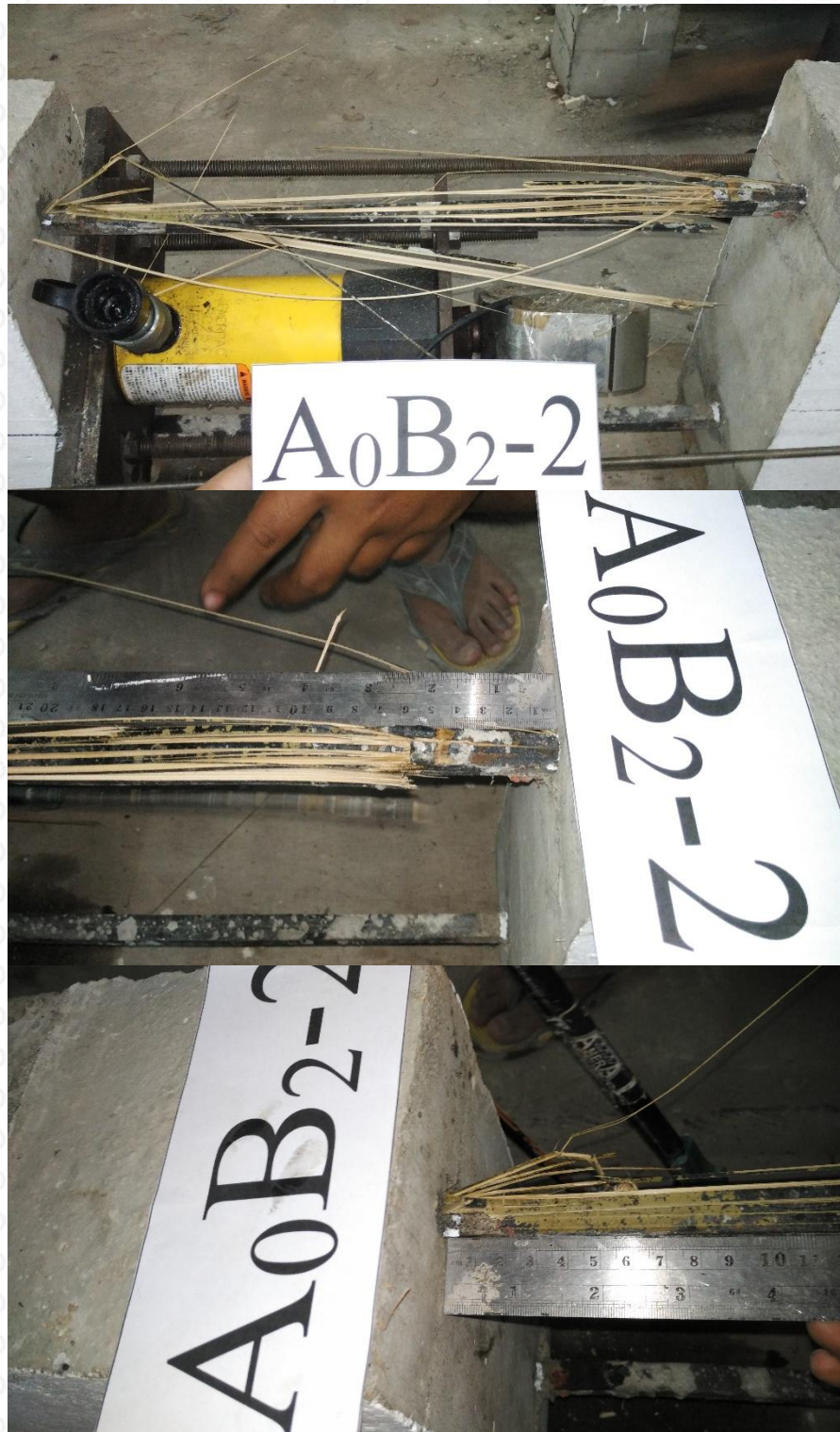
Gambar Keruntuhan Benda Uji Pull Out A 0 B 2 -2
