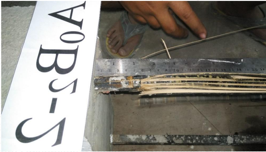
Gambar 4.23 Pola keruntuhan jenis 3 diikuti dengan pecahnya tulangan bambu
