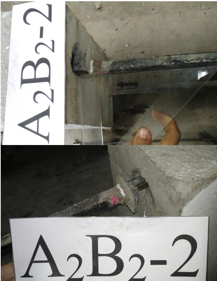
Gambar Keruntuhan Benda Uji Pull Out A 2 B 2 -2
