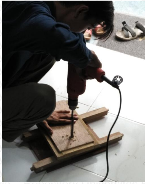
Gambar Pengukuran lubang (kiri) dan pengeboran letak tulangan bambu (kanan) pada bekesting benda Uji Pull Out
