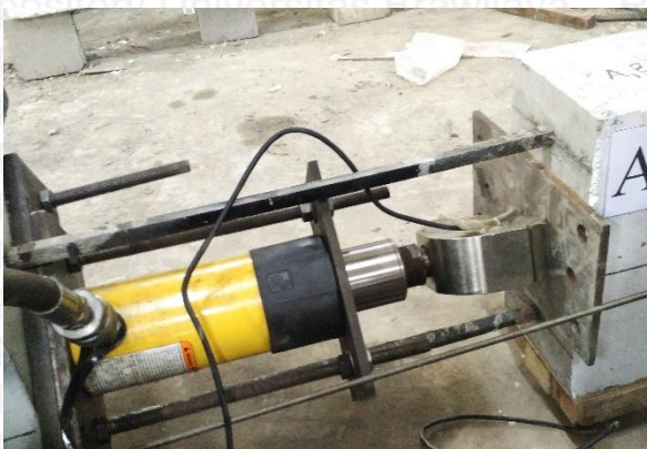
Gambar Pemasangan Hidroulic Jack dan beban pada tumpuan sendi
