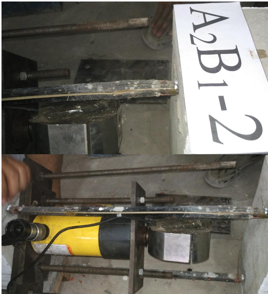
Gambar Keruntuhan Benda Uji Pull Out A 2 B 1 -2
