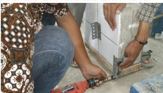
Gambar Pemasangan siku di tumpuan supaya tidak terjadi pergeseran ketika pembebanan
