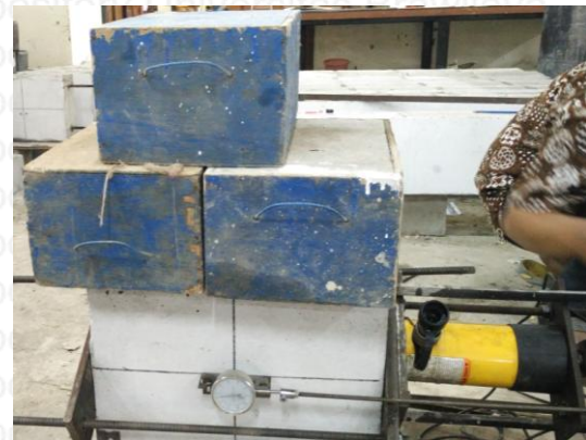
Gambar Pemasangan Hidroulic Jack dan beban pada tumpuan sendi
