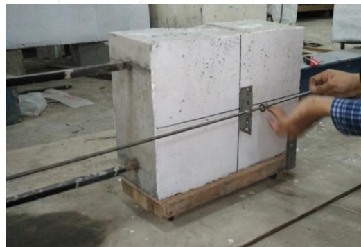
Gambar Pemasangan siku di tumpuan supaya tidak terjadi pergeseran ketika pembebanan
