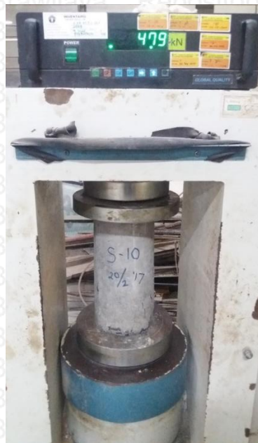
Gambar 4.1 Pengujian kuat tekan beton silinder
