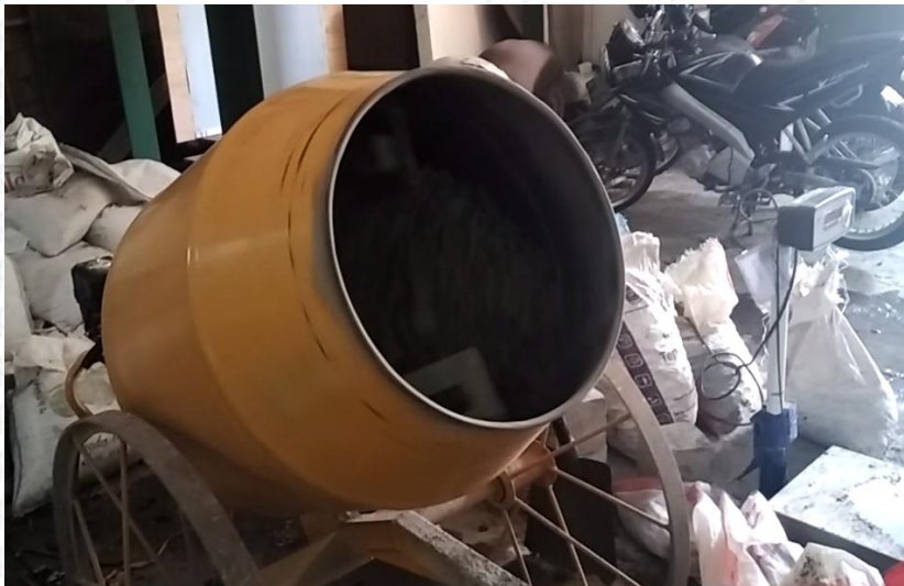
Gambar Pencampuran material beton menggunakan molen
