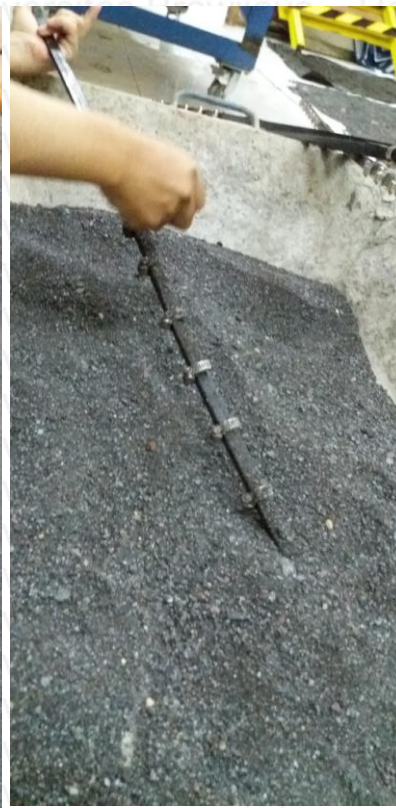
Gambar Proses Pelapisan Sikadur pada Bambu dilanjutkan dengan pelapisan Pasir
