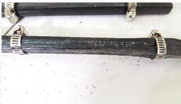
Gambar Tulangan bambu yang ditumbuhi jamur (kiri) dibersihkan dahulu sebelum ke tahap pelapisan Sikadur dan Pasir
