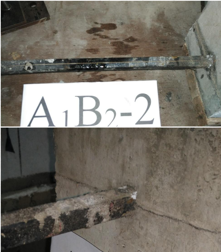
Gambar Keruntuhan Benda Uji Pull Out A 1 B 2 -2
