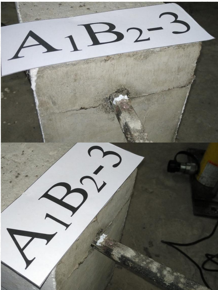
Gambar Keruntuhan Benda Uji Pull Out A 1 B 2 -3
