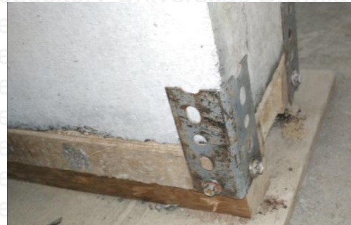
Gambar Pemasangan siku di tumpuan supaya tidak terjadi pergeseran ketika pembebanan
