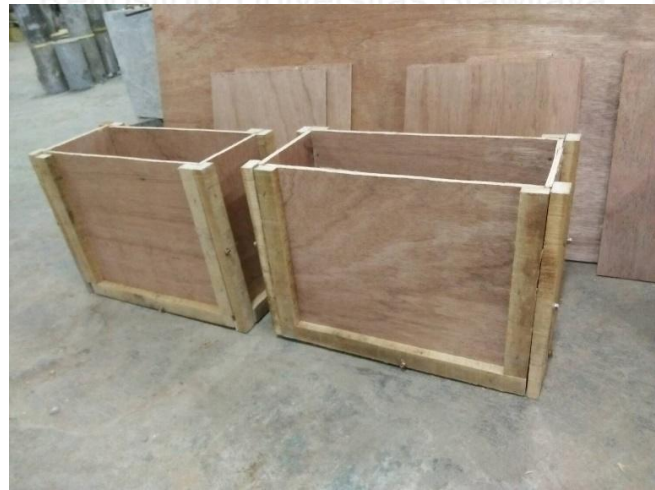
Gambar Pemasangan bagian-bagian bekesting benda Uji Pull Out
