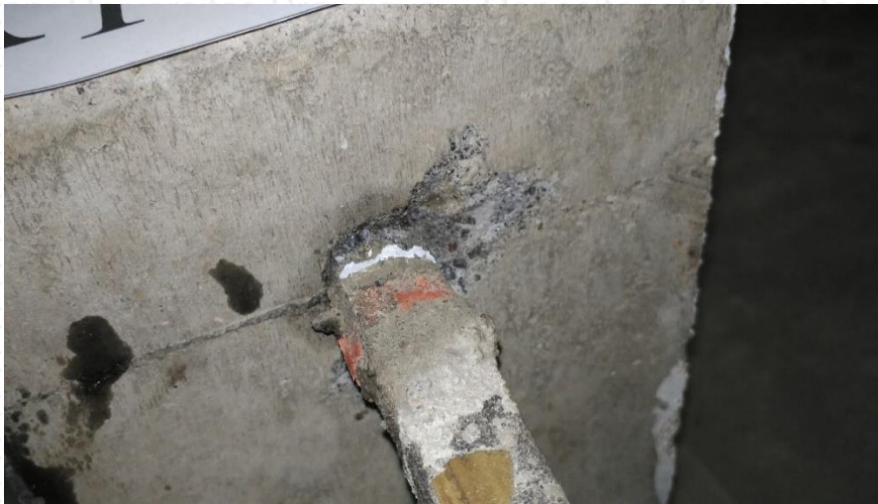
Gambar 4.24 Pola keruntuhan jenis 3 diikuti dengan pecahnya beton
