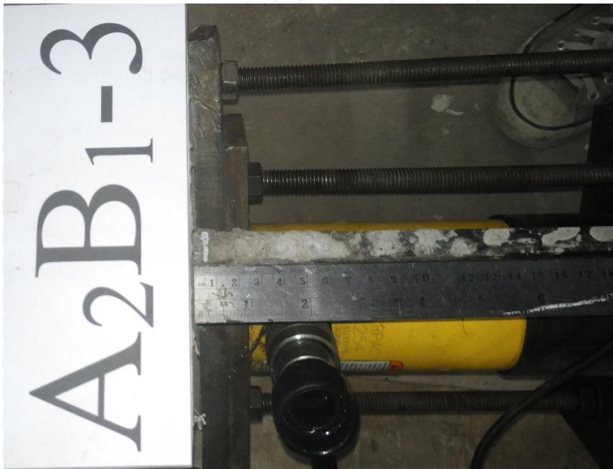
Gambar Keruntuhan Benda Uji Pull Out A 2 B 1 -3
