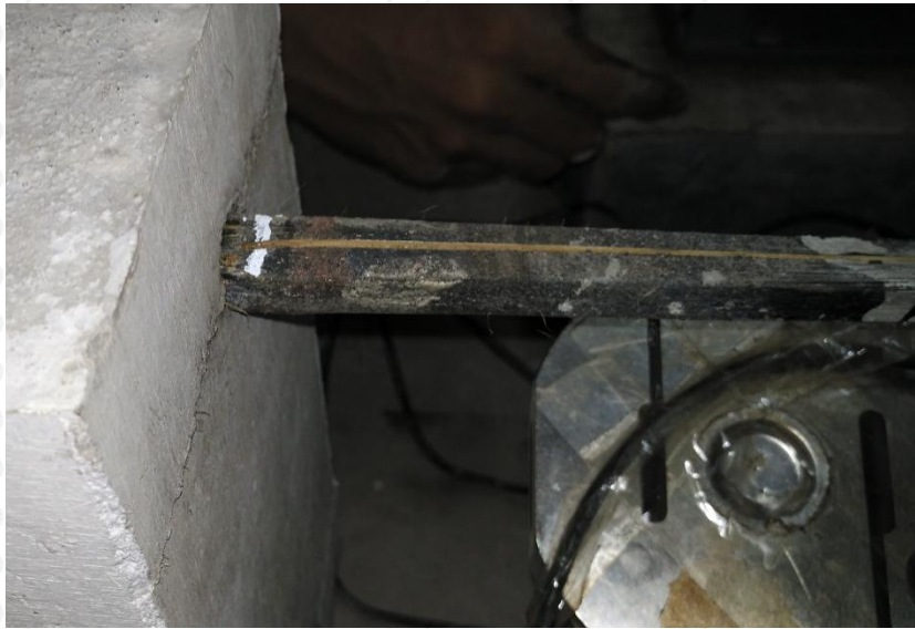
Gambar Keruntuhan Benda Uji Pull Out A 1 B 1 -3
