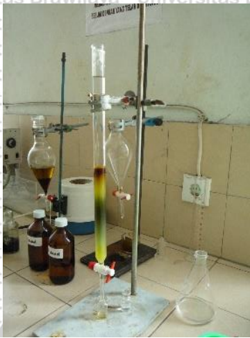
Kromatografi Kolom dengan Fase Gerak n-heksan : EtOAc (7.5 : 2.5)
