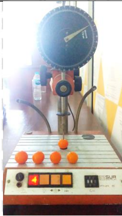
Pengukuran kekerasan buah menggunakan alat penetrometer merk "SUR Berlin" tipe PNR 6.
