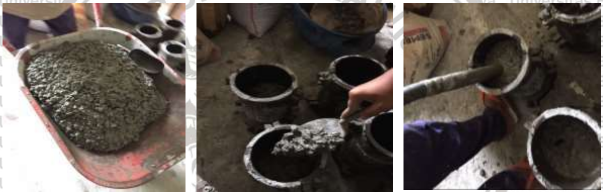
Gambar 4.4. Proses Penuangan dan Pematatan Beton Segar
