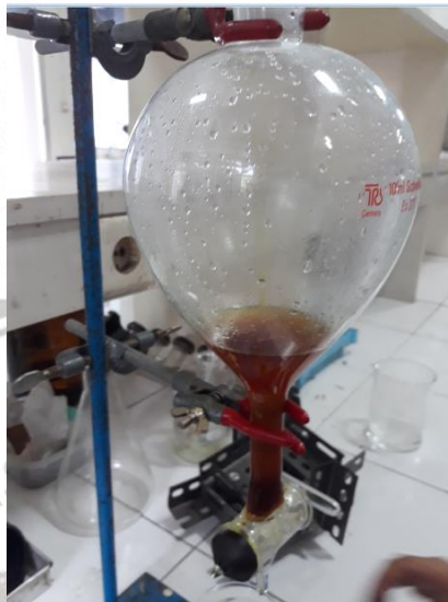
Gambar 5.9 Proses Pemisahan Air dan Minyak dengan Menggunakan Corong Pemisah
