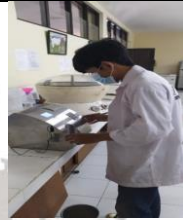
Keterangan : Pengujian susu dengan lactoscan
