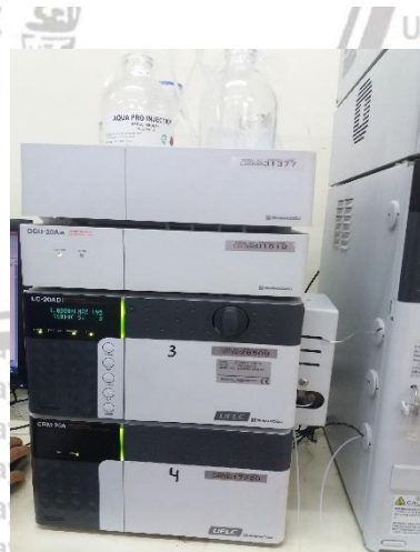
Injeksi sampel dan pemantauan tekanan HPLC
