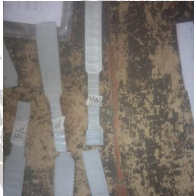
Gambar 3. 10 Patahan Yang Terjadi Pada Saat Pengujian Tarik
