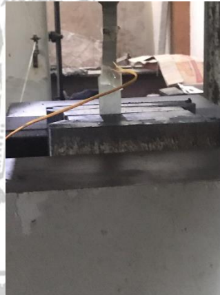
Gambar 3. 8 Alat dan Sampel Pengujian Tarik Dengan Strain Gauge
