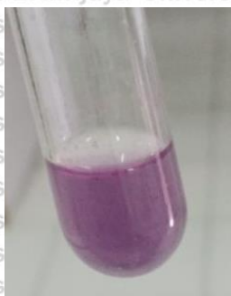
Gambar 5. 7. Hasil Skrining Fitokimia Senyawa Saponin. Keterangan : tidak terdapat buih pada sampel uji setelah dilakukan pengocokan dan dibiarkan selama 10 menit.
