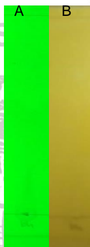
Gambar 5. 2. Plat KLT Hasil Skrining Fitokimia Senyawa Fenol . Keterangan : (A) Plat KLT sebelum diberi penampak noda \text{FeCl}_3 dan diamati pada UV 254 nm; (B) Plat KLT sesudah diberi penampak noda \text{FeCl}_3 dan diamati pada sinar tampak
