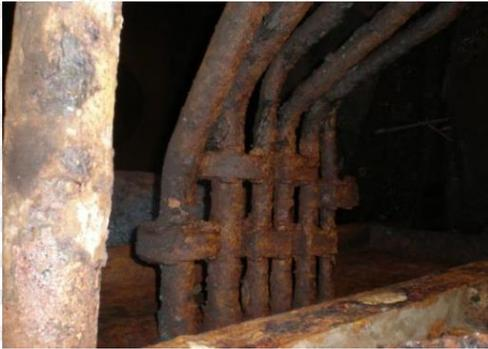
Gambar 2.10 Korosi seragam pada pipa ballast
