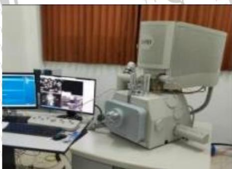
Gambar 3.3 Alat uji SEM-EDS
