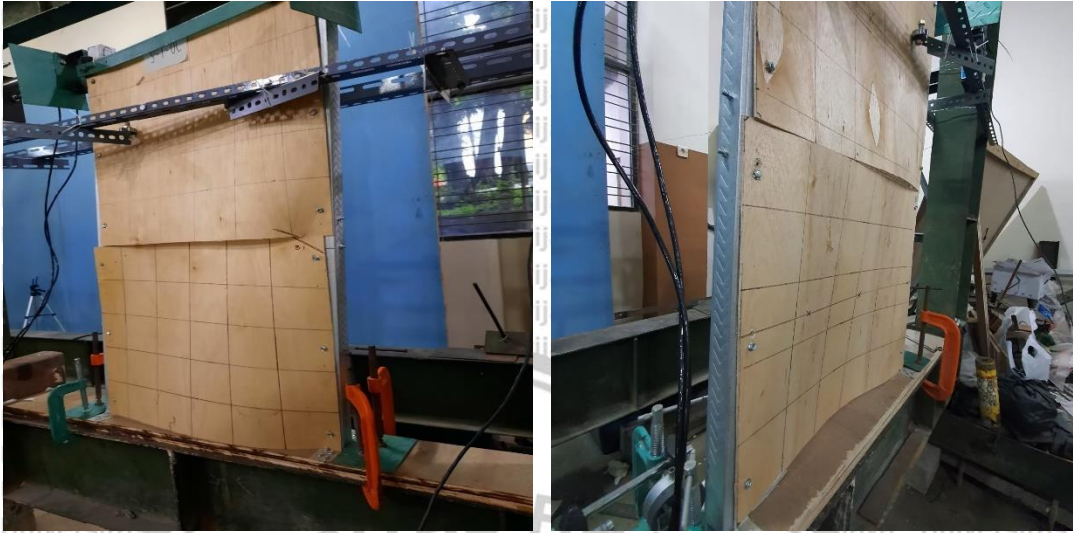
Gambar 4.24 Kondisi material multiplek saat pembebanan yang mengalami tekuk
