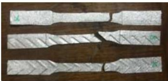
Gambar 2.8 Sampel uji tarik canai dingin yang mengalami putus Sumber : Kusuma P A (2020)
