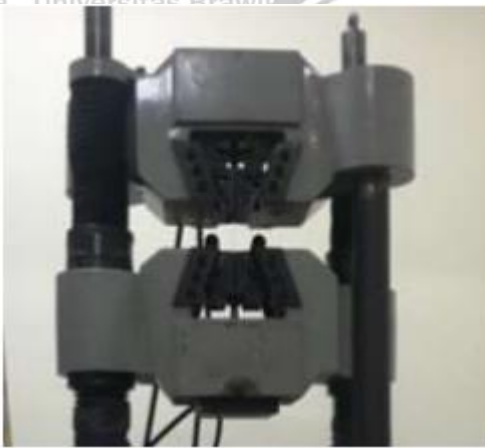
Gambar 2.7 Alat uji tarik baja Sumber : Kusuma P A, 2020
