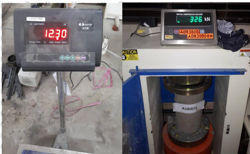
Gambar 4. 6 Uji Tekan Beton menggunakan Compression test machine
