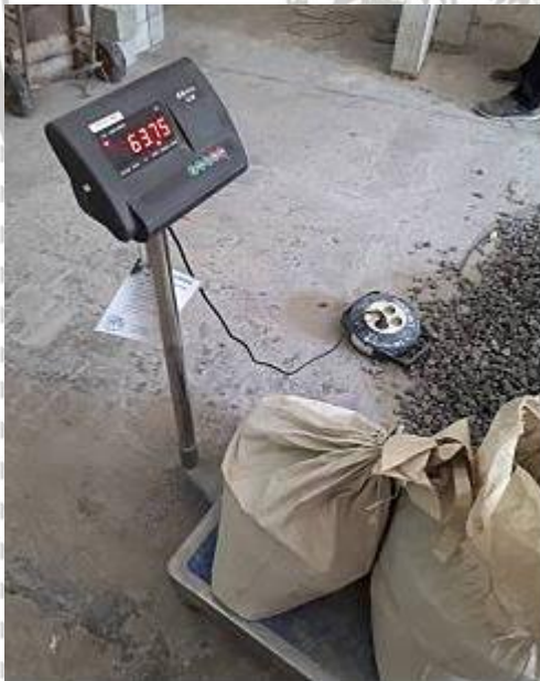
Gambar 4.2 Penimbangan bahan sesuai dengan perhitungan mix design
