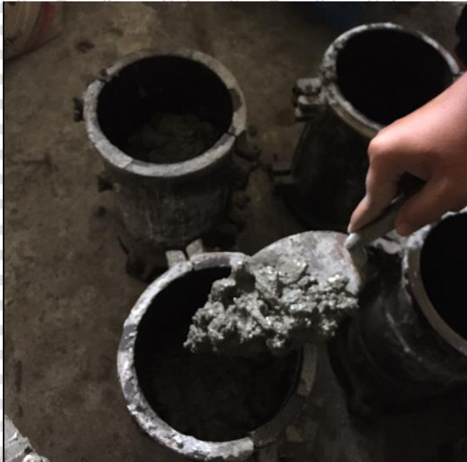
Gambar 4. 5 Penuangan campuran ke dalam bekisting benda uji Sumber: Dokumentasi Peneliti
