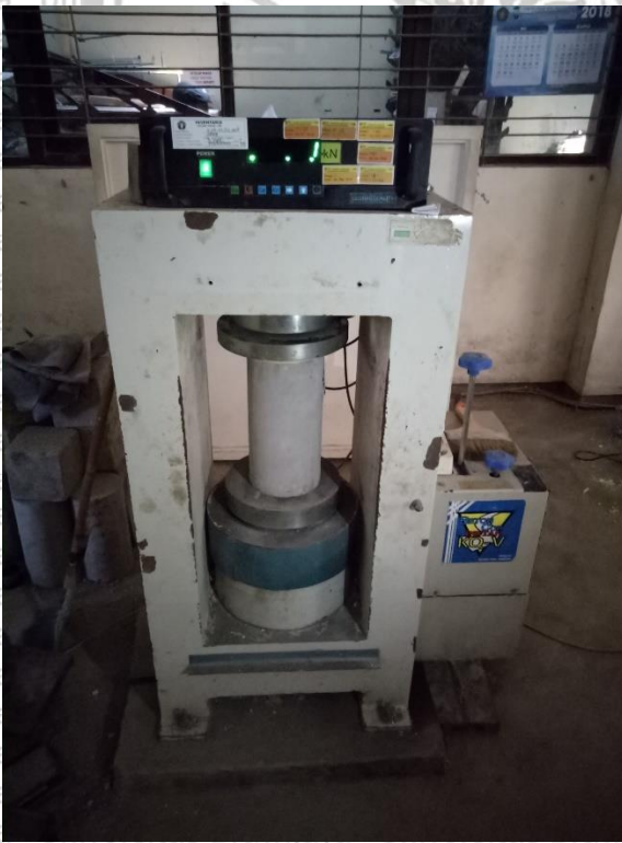
Gambar L.2.16 Pengujian Kuat Tekan Silinder
