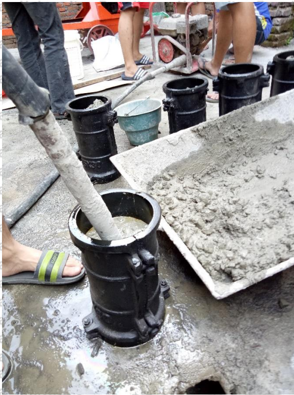
Gambar L.2.11 Pematatan Beton dengan Vibrator
