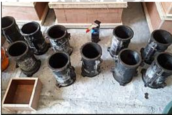
Gambar 4.4 Pelapisan bekisting benda uji dengan oli Sumber: Dokumentasi Peneliti
