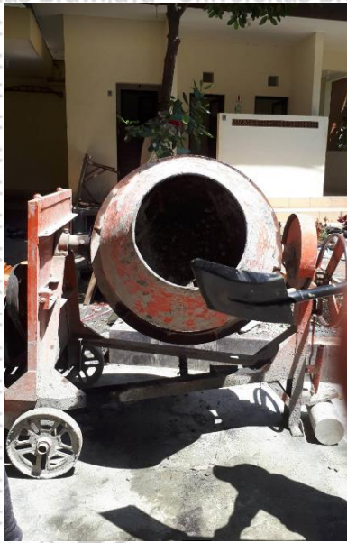
Gambar 4.3 Pencampuran material pada mesin pengaduk Sumber: Dokumentasi Peneliti
