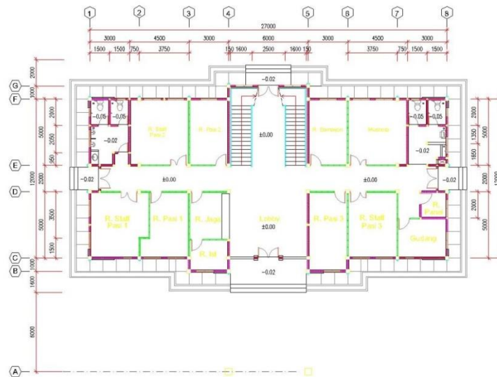
Gambar 4.2 Denah Lantai Dasar Gedung Markas Komando
