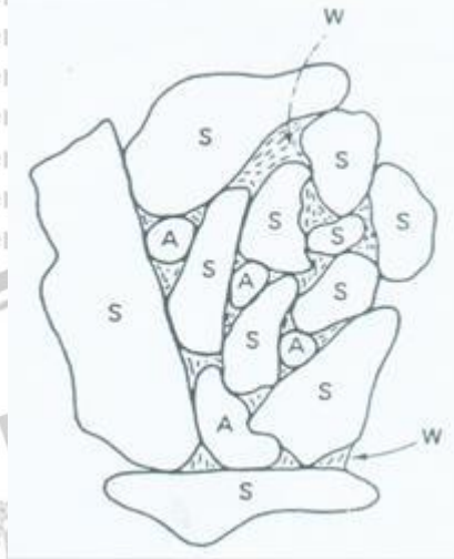
Gambar 2.1 Kerangka Tanah Berisi Butiran/ Solids Particels (S), Pori/Void dengan Udara/Air (A) dan Air/Water (W)
