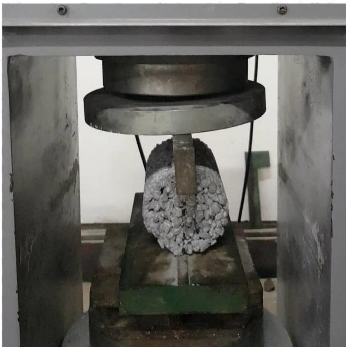
Gambar 4. 8 Pengujian kuat tarik belah beton porous
