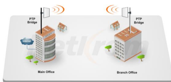
Gambar 2. 3 Ilustrasi komunikasi point to point
