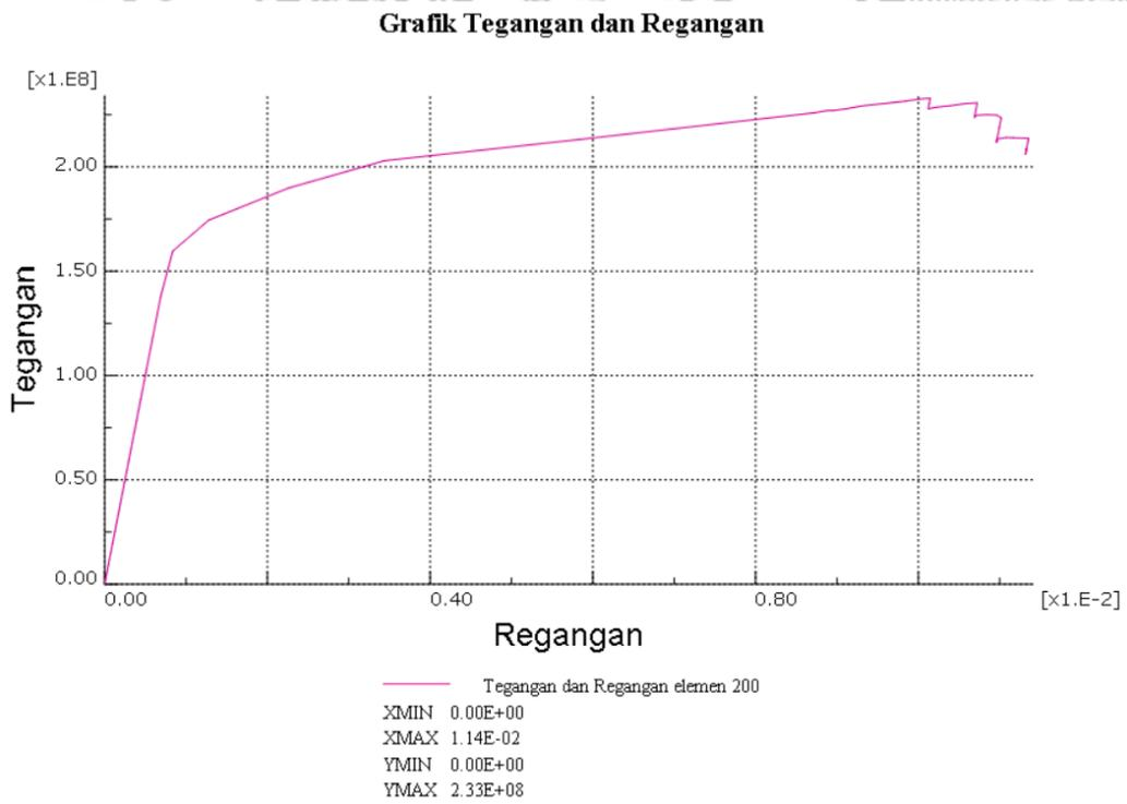
Gambar 4.19 Grafik tegangan dan regangan elemen 200
