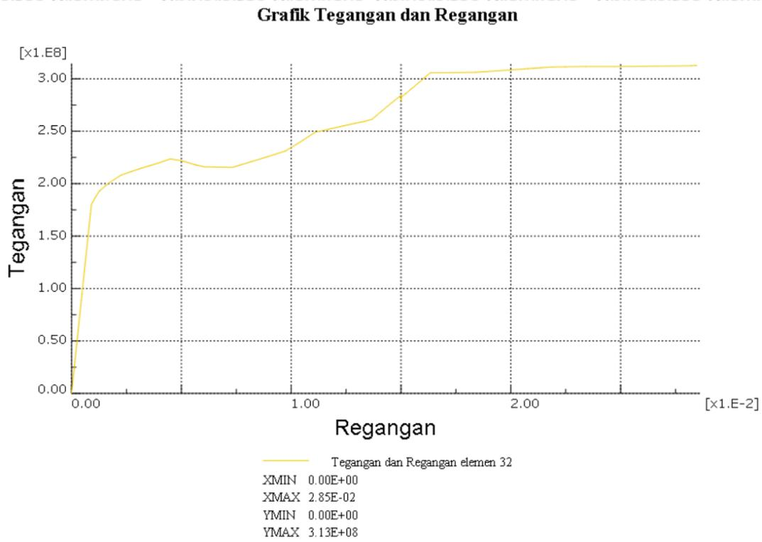
Gambar 4.29 Grafik tegangan dan regangan elemen 32
