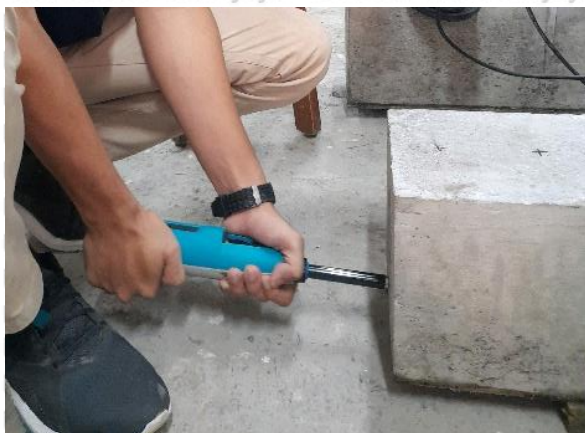
Gambar 4. 5 Pengujian Kuat Tekan Hammer Test
