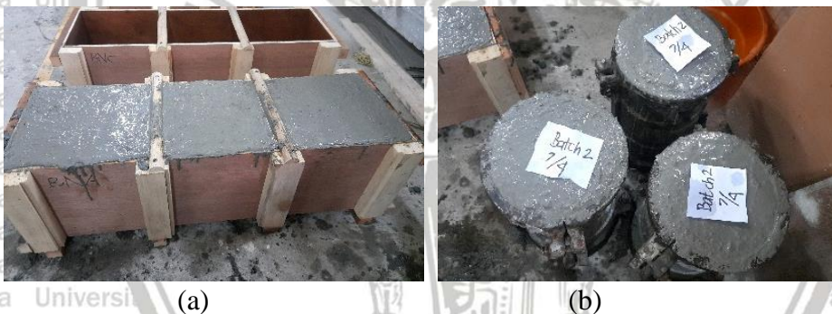
Gambar 4. 2 (a) Benda Uji pada Bekisting Balok (b) Benda Uji pada Cetakan Silinder
