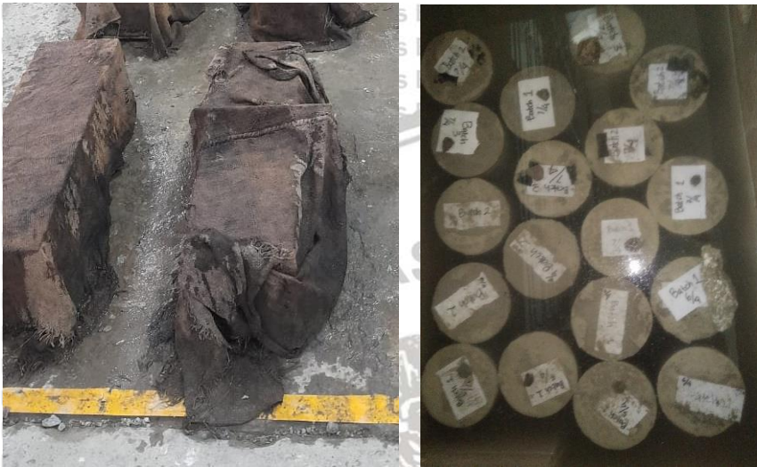
Gambar 7. Perawatan benda uji (a) balok (b) silinder
