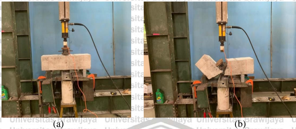
Gambar 4. 11 Pengujian Kuat Lentur (a) Perletakan Benda Uji (b) Benda Uji Hancur
