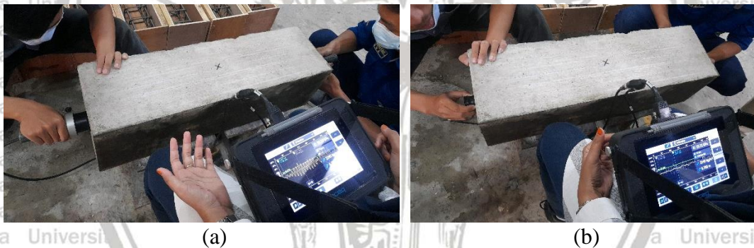
Gambar 10. Pengujian modulus elastisitas dinamis menggunakan transducer (a) P-wave (b) S-wave
