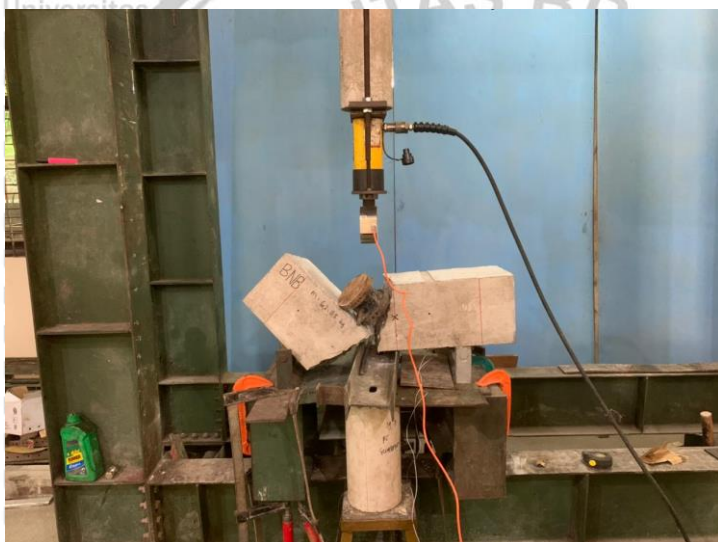
Gambar 21. Kondisi balok saat menerima beban maksimum
