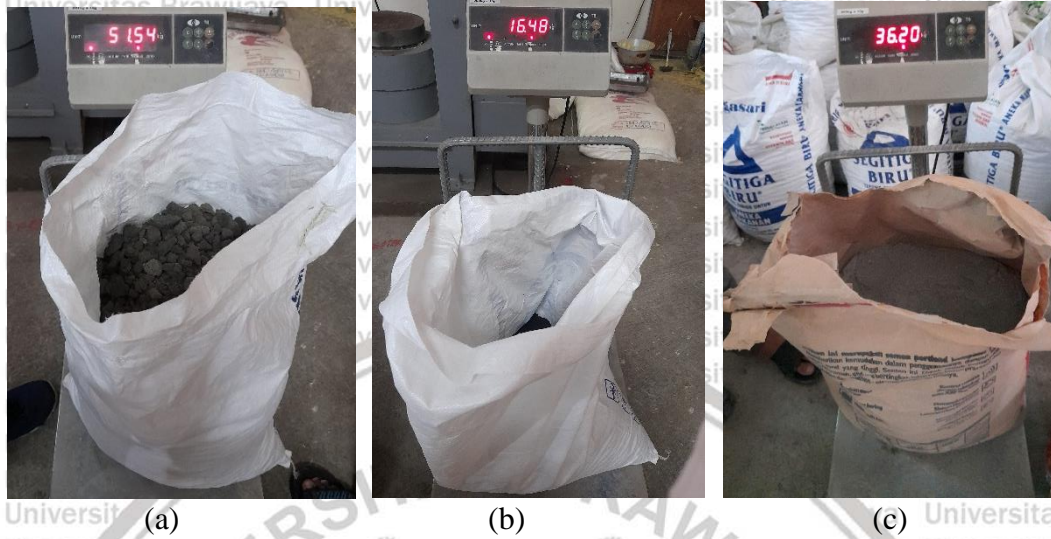
Gambar 1. Persiapan benda uji dengan menimbang bahan campuran beton (a) Kerikil; (b) Pasir (c) Semen
