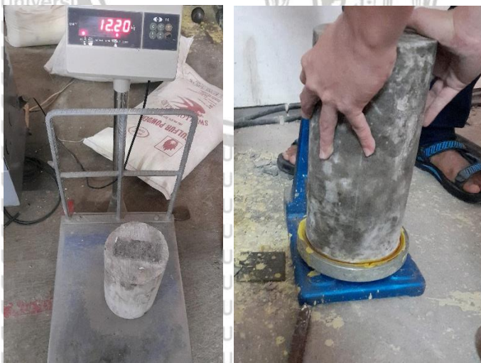
Gambar 8. Persiapan pengujian kuat tekan (a) menimbang benda uji silinder (b) caping benda uji silinder
