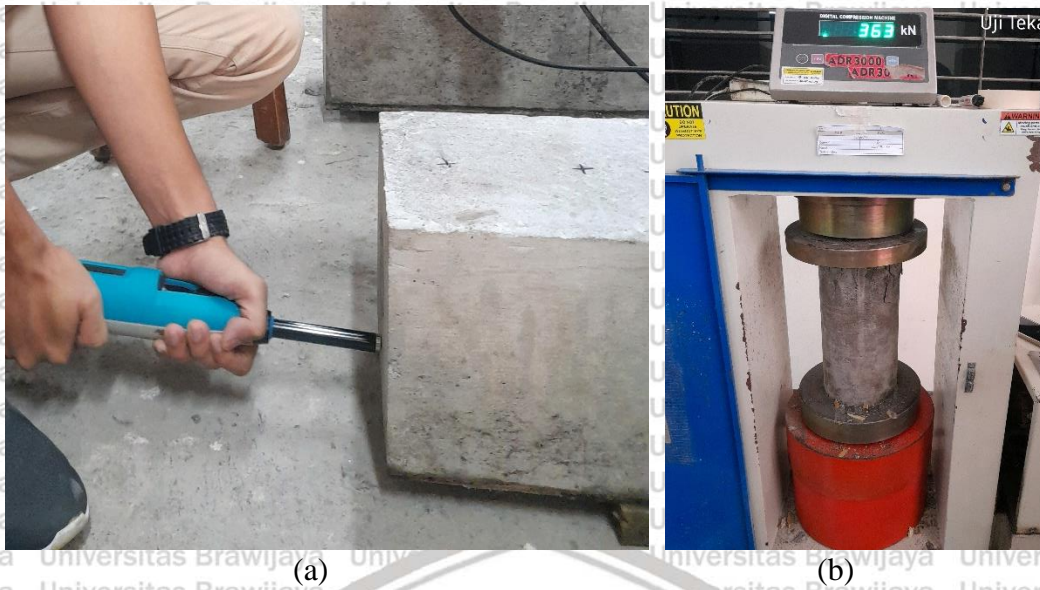
Gambar 9. Pengujian kuat tekan menggunakan (a) Rebound Schmidt Hammer pada benda uji balok (b) Compression Test Machine (CTM) pada benda uji silinder
