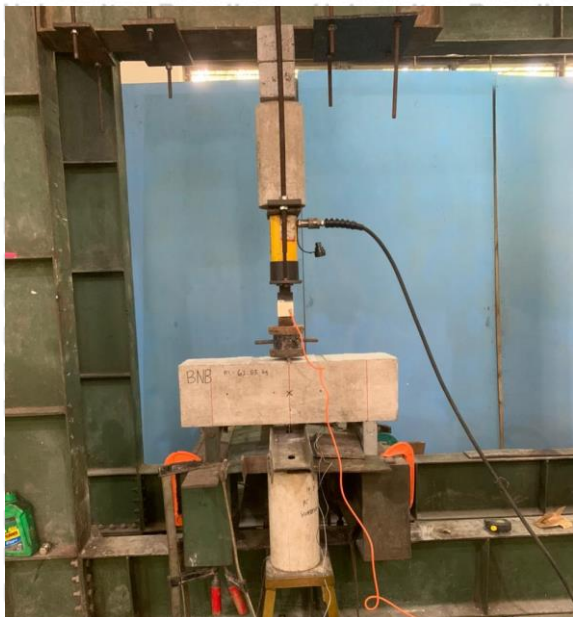
Gambar 21. Peletakan benda uji pada tumpuan yang telah disiapkan
