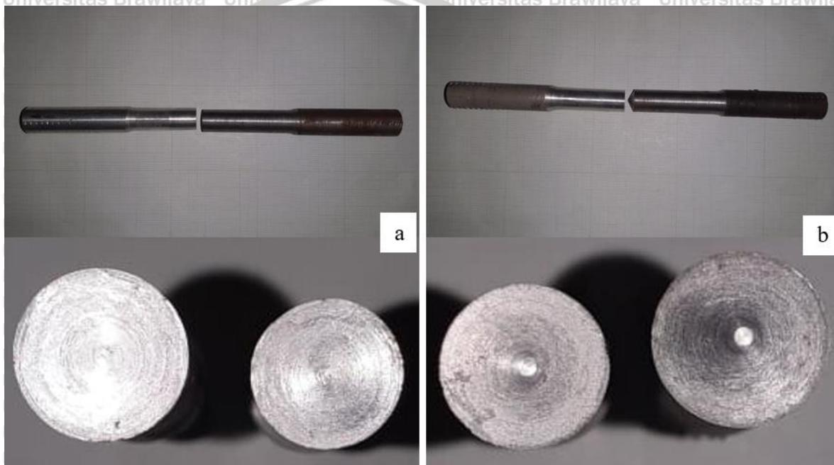
Gambar 4.3 Foto makrostruktur patahan spesimen las gesek (a) spesimen las kekuatan tarik terendah dengan variasi tanpa *chamfer* dan tanpa *aging* (b) spesimen las dengan kekuatan tarik tertinggi dengan variasi *chamfer* 30° dan suhu *aging* 125°C.
