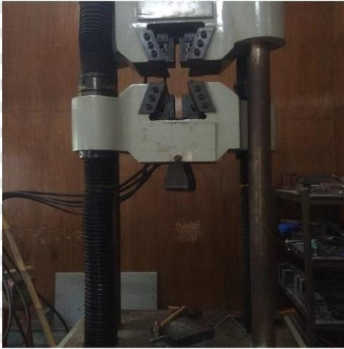
Gambar 3.6 Mesin uji tarik
