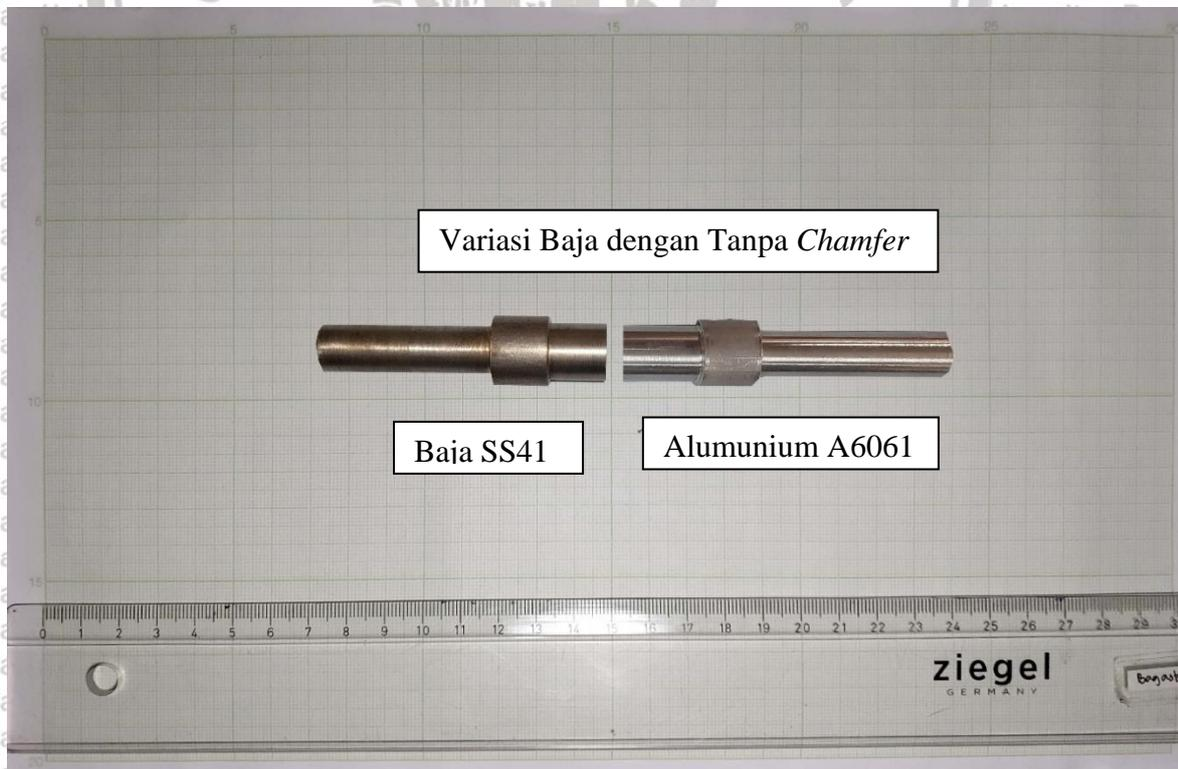
Lampiran 7 Foto Spesimen Setelah Pengelasan
