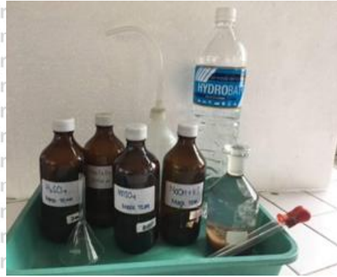
Menunggu sampai mengendap dan hitung nilai DOnya. BOD 5 disimpan dalam desikator selama 5 hari dan hitung nilai BODnya
