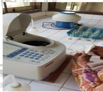
Memasukkan sampel yang sudah diberi larutan Nessler ke dalam cuve t dan hitung dengan spektrofotometer
