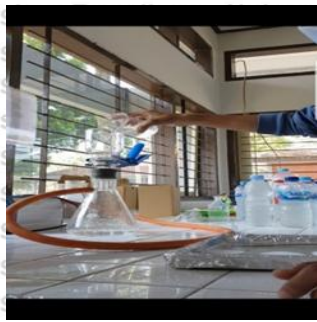
Menyaring air sampel dengan kertas saring menggunakan vacuum pump
