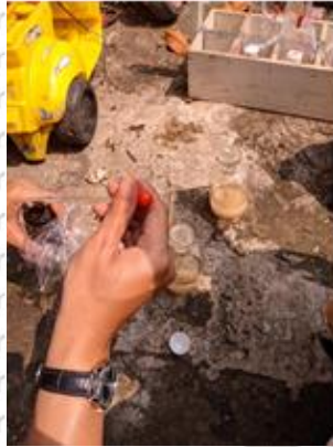
Pengukuran BOD 1 dilakukan di lapang menggunakan metode titrasi winkler
