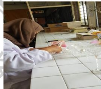
Menyaring air sampel ke dalam beaker glass
