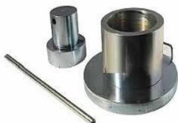
Gambar 2.3. Silinder baja, besi penusuk dan plunger
