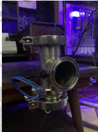
Gambar 2. 5 Alat ohmic yang digunakan (Sumber: Dokumentasi Penulis)
