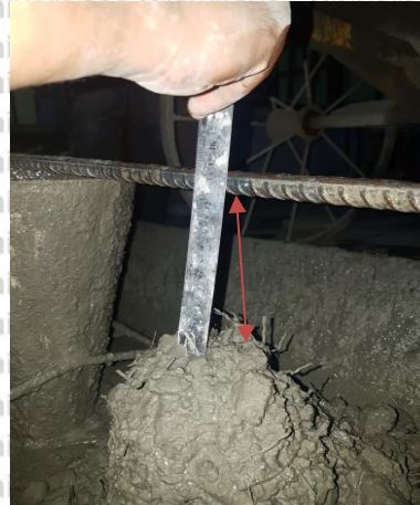
Gambar 4.2 Uji Slump dengan fiber
