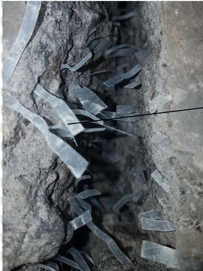
Gambar 4.4 Model kehancuran beton serat plastik setelah uji tarik
