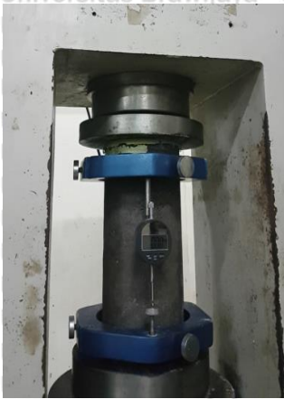
Gambar 4.7 Proses pengujian kuat tekan menggunakan ekstensometer
