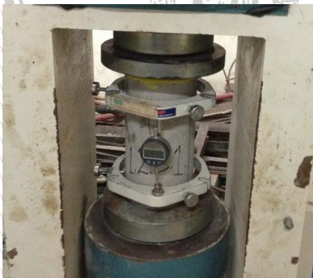
Gambar 2.7 Uji Modulus Elastisitas menggunakan extensometer
