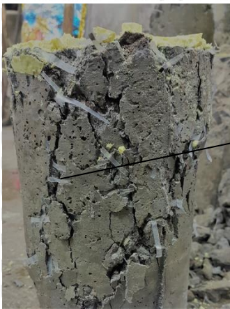
Gambar 4.5 Model kehancuran beton berserat
