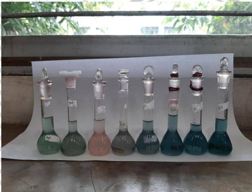
**Gambar 4.7.** Pengamatan larutan pengujian kadar ammonia pada sampel pupuk ZA
